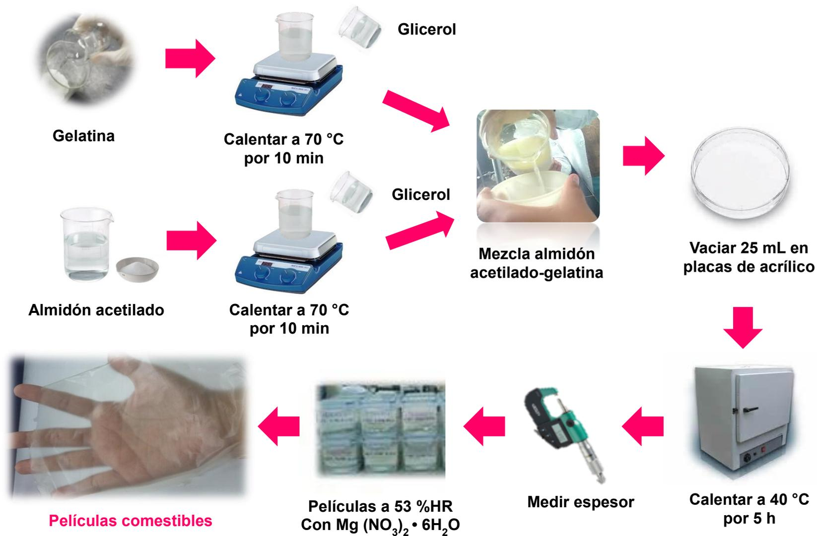
**Figura 8.** Esquema de la elaboración de películas comestibles de gelatina, almidón acetilado y glicerol.
