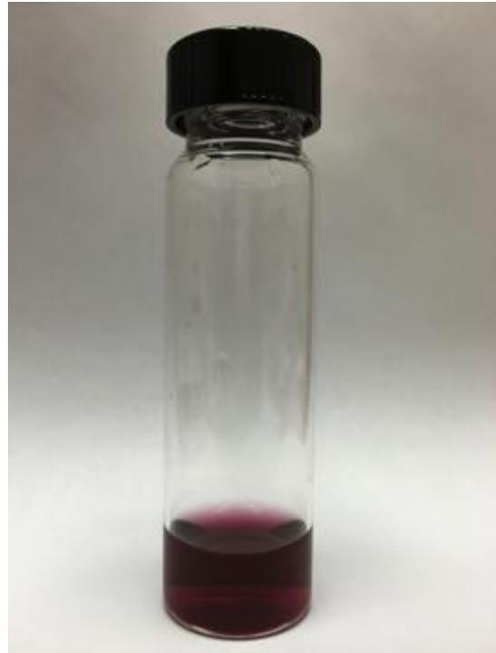
**Figura 14.** Síntesis de nanopartículas de oro usando melaninas dializadas de uvalama. Se muestra un cambio de color de café a violeta brillante debido a la reducción del  $\text{HAuCl}_4$  a AuNPs después de 30 min de incubación.
