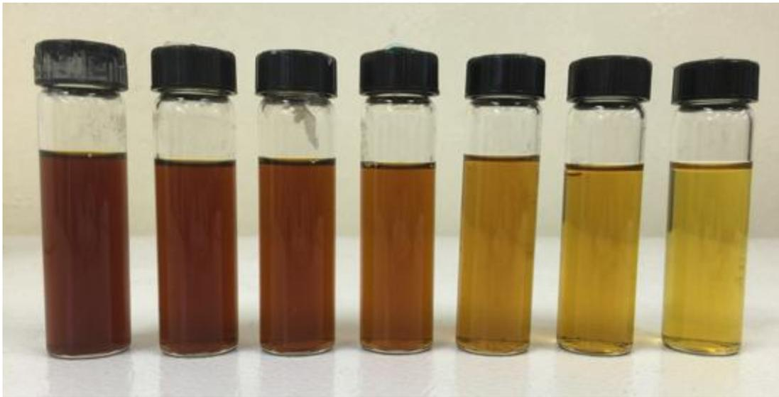
**Figura 11.** Síntesis de nanopartículas de plata usando diferentes concentraciones de melaninas dializadas de uvalama (0.5-10 mg/mL). Se muestra un cambio de color de café a amarillo brillante debido a la reducción del  $\text{AgNO}_3$  a AgNPs después de 15 h de incubación.
