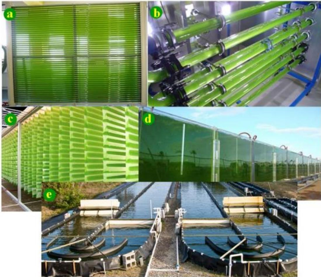
**Figura 1.** Sistemas de cultivo de microalgas. a) Fotobiorreactor tubular; b) Fotobiorreactor tubular; c) Vertical; d) Fotobiorreactor tipo placa y e) Lagunas abiertas (LA) también conocidas como “raceway”. Tomado de Loera-Quezada y Olguín (2010)
