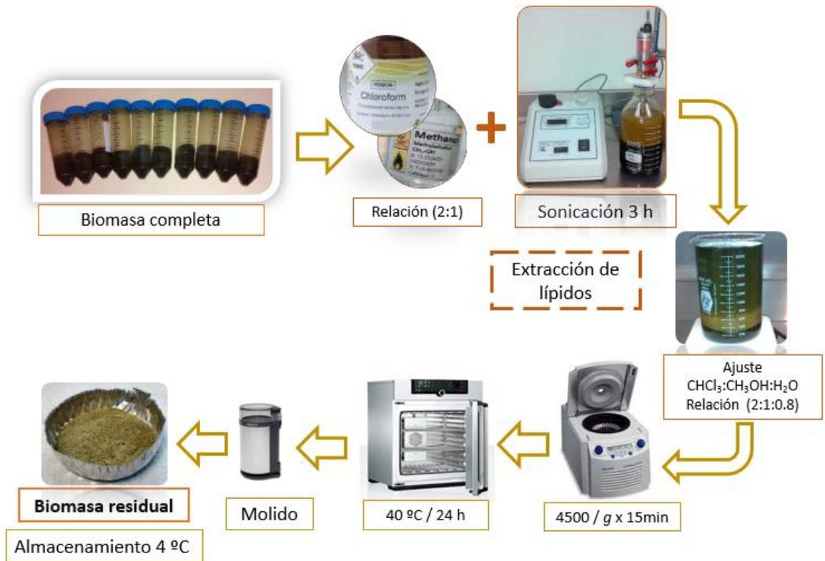
**Figura 7.** Diagrama de flujo para obtención de la BR de *P. tricornutum*
