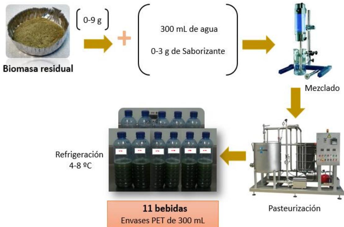
**Figura 9.** Diagrama de flujo del proceso para la elaboración de bebidas funcionales
